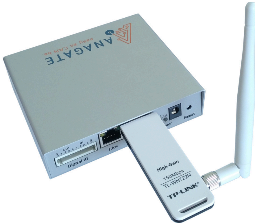
Abbildung 2.4. AnaGate CAN F4 mit WLAN-USB-Adapter
