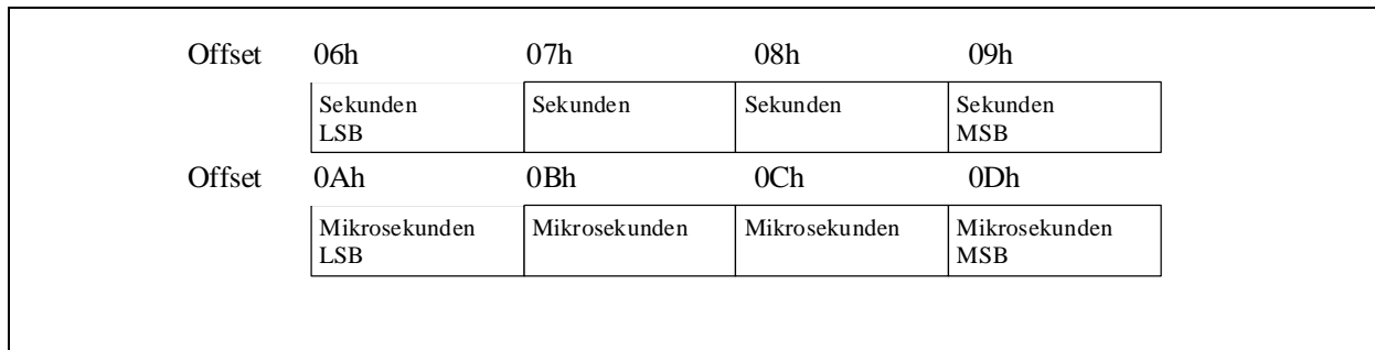
Abbildung 3-36: Telegrammaufbau für OP_ANAGATE_CAN_SET_TIME_REQ
